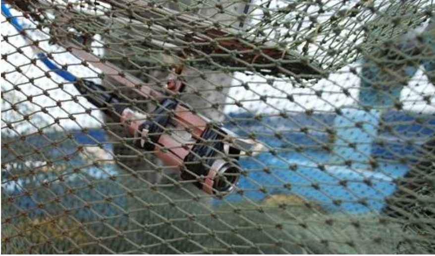
Şekil 3.2.13. Bowtech LCC 600 ve bağlantı aparatları.
