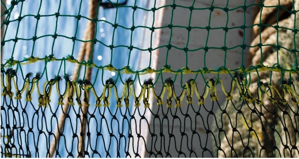
Şekil 3.3.5. Kare gözlü torbanın ağın uzatma parçasıyla birleştiği kenar.
