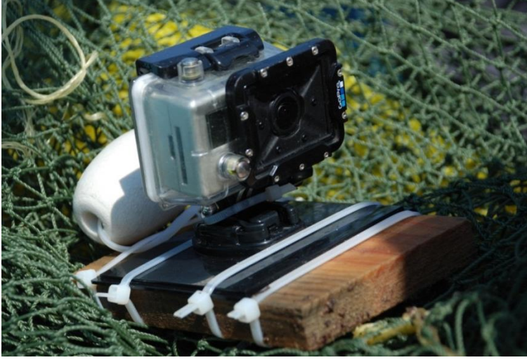
Şekil 3.2.18. Izgaranın önüne ahşap materyalle sabitlenmiş GoPro Hero 2.
