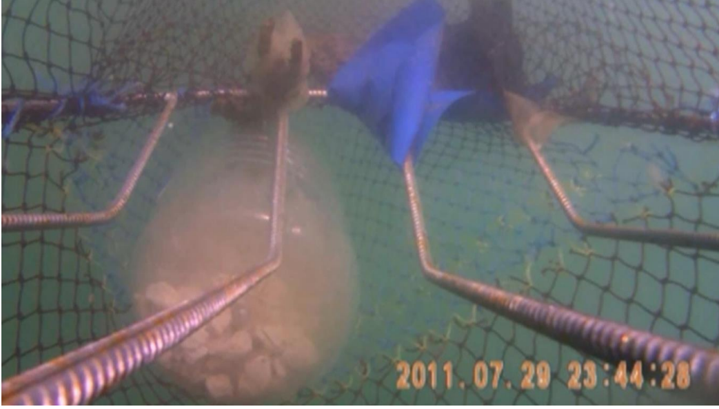
Şekil 4.2.32. Izgara kaçış boşluğundan dışarıya çıkan 8 litrelik su şişesi.
