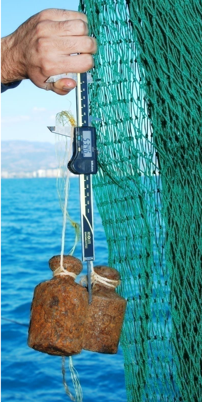
Şekil 3.3.6. Kumpas ve 4 kg ağırlıkla ağ gözü ölçümü.
