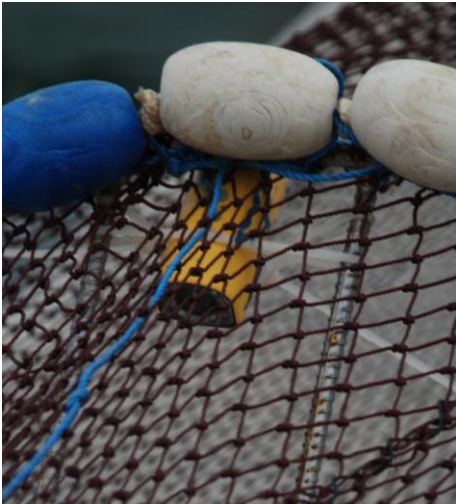
Şekil 3.2.20. Kablo kelepçeyle ızgaranın üzerine sabitlenmiş RD32.
