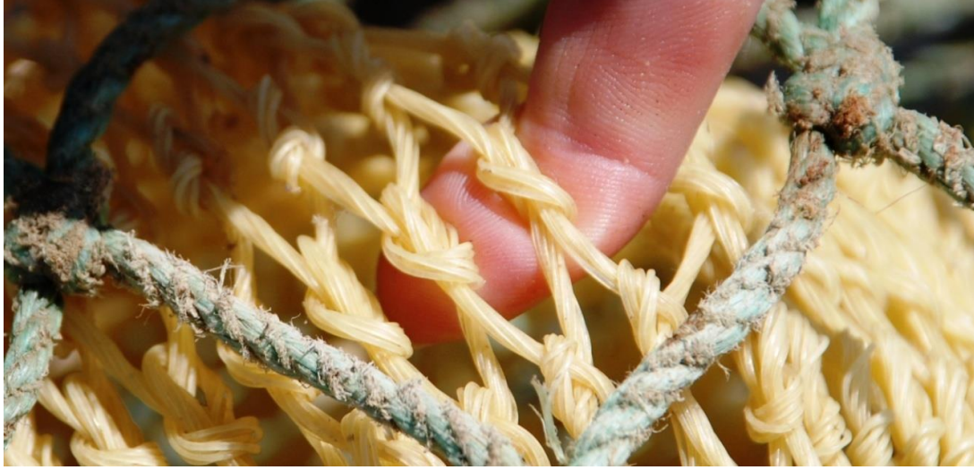
Şekil 3.3.3. Mersin Körfezi dip trolü avcılığında yaygın olarak kullanılan 44 mm el örmesi PE torba ve PP muhafaza ağı.
