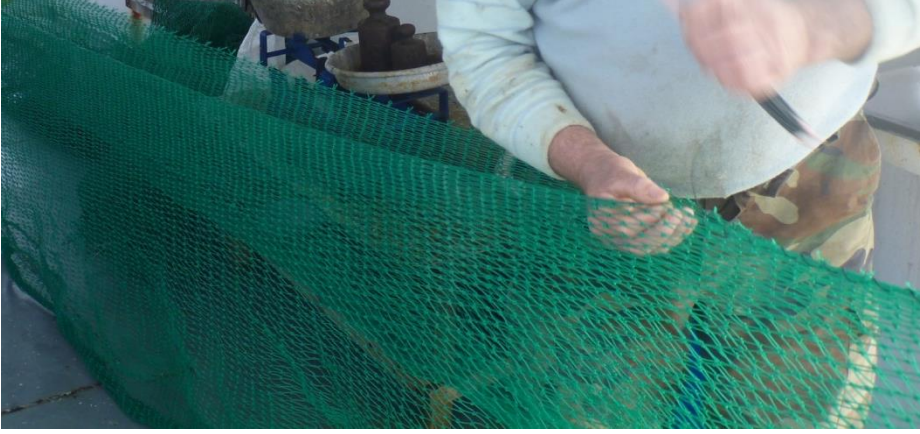
Şekil 3.3.14. Çevre göz sayısı 150 olan 44 mm baklava gözlü torba.
