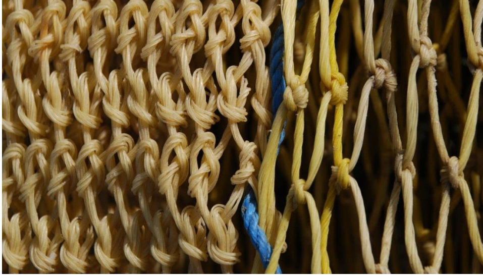
Şekil 3.2.25. 50 göz B44 ile 50 göz T44 ağlar birleştirilerek elde edilen torba.
