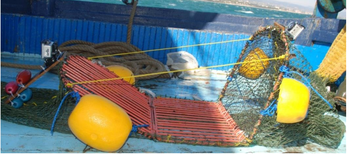
Şekil 3.2.21. JTED kaçış boşluklarına donatılmış GoPro Hero 2 ve GoPro Hero.
