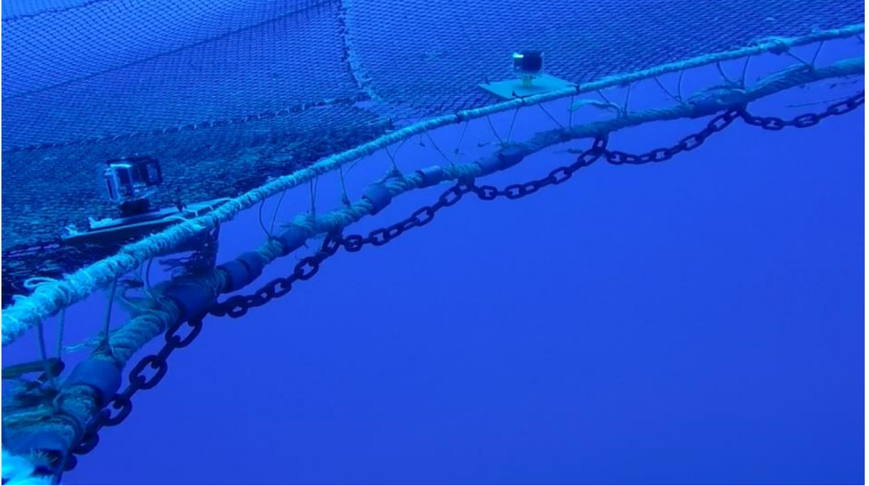
Şekil 4.25. T600 ağına ait kurşun yakanın zincir donamının sualtı görüntüsü
