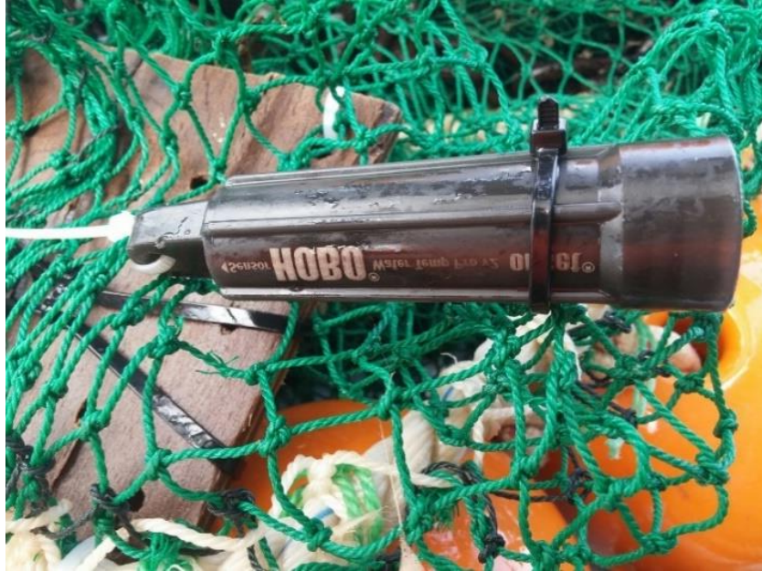
Şekil 3.5. 120 m'ye kadar sıcaklık kaydedici cihaz (Hobo, Pendant, U22-001)
