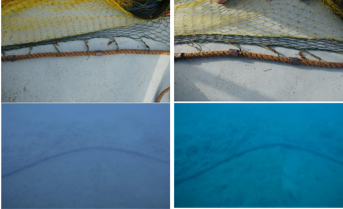
Şekil 3.31. Geleneksel (sol) ve ağırlaştırılmış (sağ) kurşun yakanın güverte ve sualtı görüntüsü
