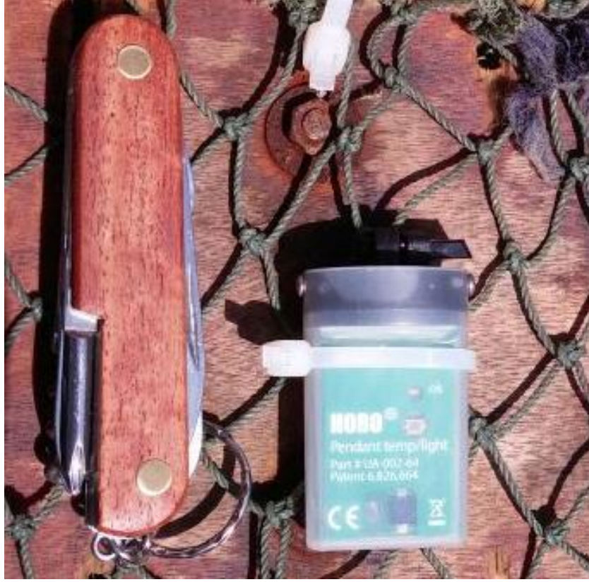
Şekil 3.4. Otuz m'ye kadar sıcaklık kaydedici cihaz (Hobo, Pendant, UA002)
