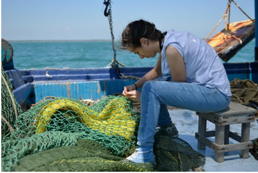
Şekil 3.21. 44 mm el örmesi gevşek düğümlü PE torba (sarı) ve 88 mm PP muhafaza (yeşil)
